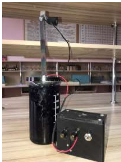
Фото2. Прибор для химического окрашивания деталей
